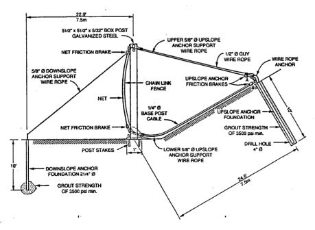
FIGURE 4: SIDE VIEW OF THE INDUSTRIAL ENTERPRISE ROCK NET
